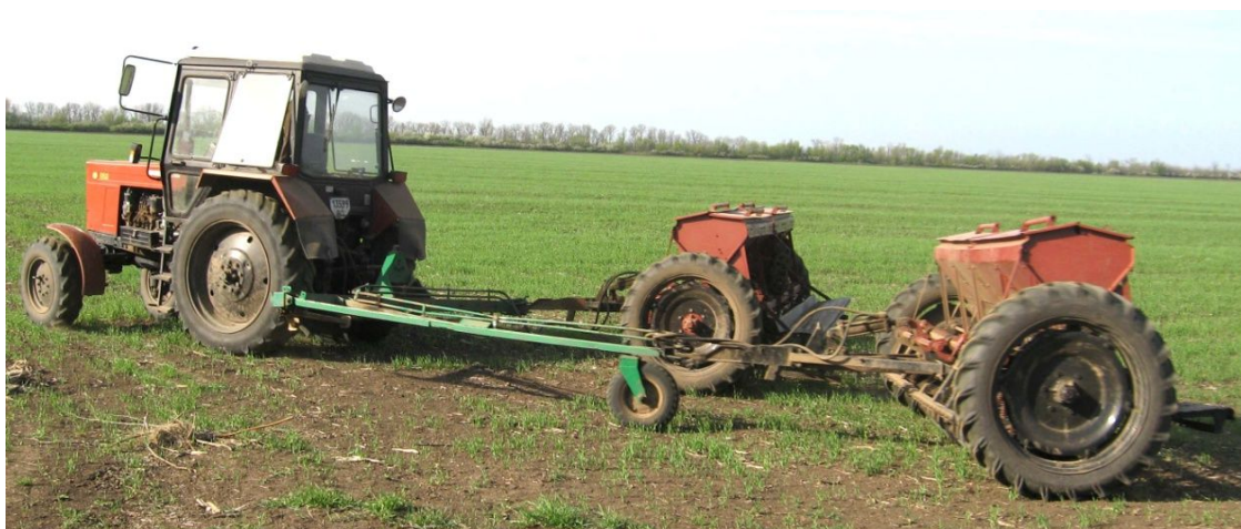
Рис. 2. Дослідний двомашинний агрегат під час повороту
