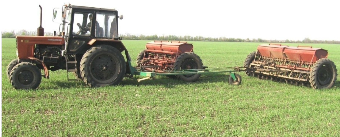
Рис. 1. Двомашинний МТА на підживленні сходів озимої пшениці
