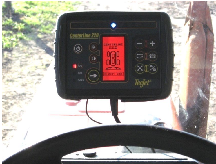
Рис. 3. Кабіна трактора, обладнана GPS-навігатором
