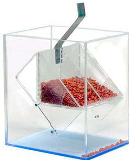
Рис. 4. Лабораторна установка для визначення кута природнього укосу типу УВТ-3М
