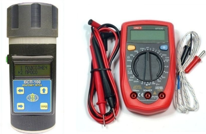
Рис. 1. Лабораторний вологомір ВСП-100 та мультиметр UNI-T UMT133C з термопарою
