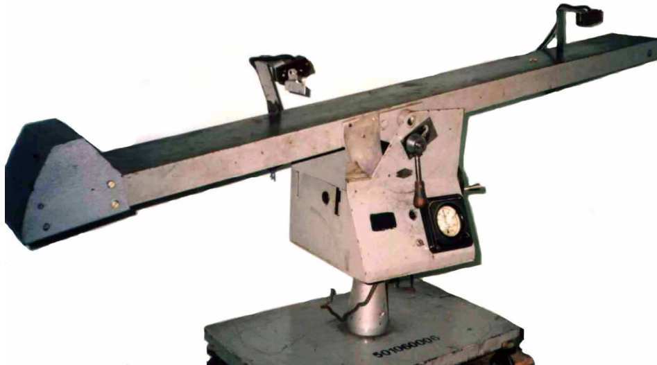
Рис. 3. Лабораторна установка для визначення коефіцієнту тертя ТМ21-А
