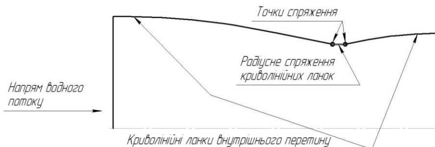
Рис.2. Внутрішній перетин пропонованої конструкції насадок для фонтанів
