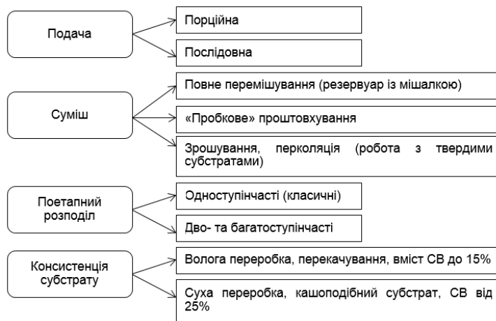
Рис. 1. Особливості конструкцій біогазових установок Fig. 1. Features of designs of biogas plants
