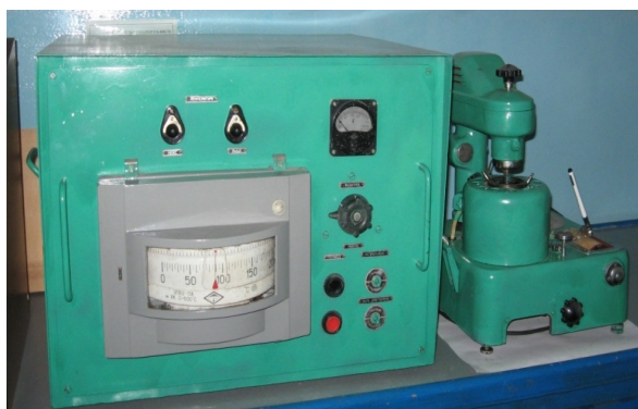
Рис. 1. Загальний вид машини тертя МАСТ-1 Fig. 1. General view of friction machine MAST-1
