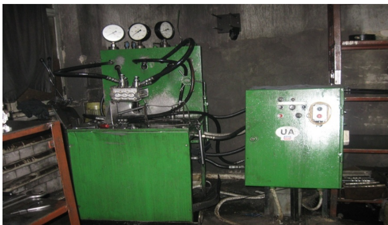
Рис. 5. Загальний вигляд експериментальної установки для випробування елементів гідросистем
