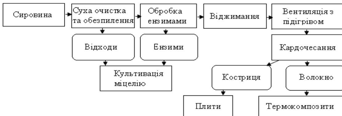
Рис. 1. Схема переробки соломи льону олійного у плити та композиційні матеріали
