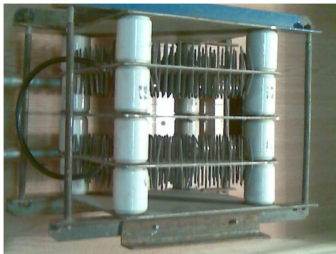
Рис.1. Проточний електроозонатор в воздуховоді сушилки.
