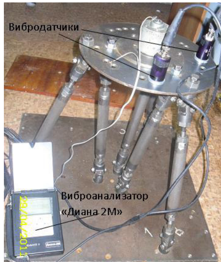
Рис. 8. Экспериментальная установка в положении, соответствующем наибольшей жесткости.
