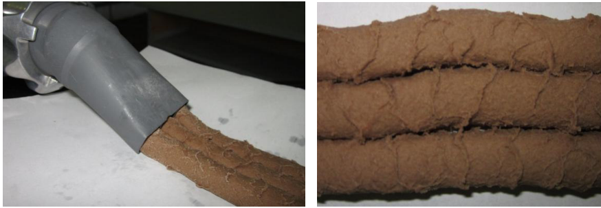
Рис. 2. Нерівномірність виходу джгутів та неякісна поверхня виробів.
