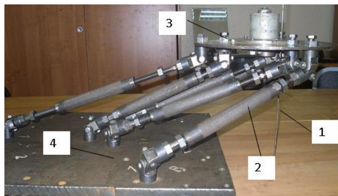
Рис. 4. Механизм параллельной кинематики в правой крайней точке.
