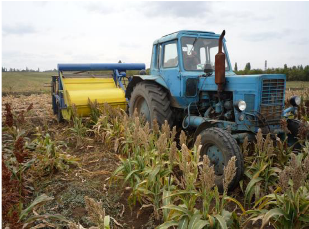
Рис. 1. Полевые испытания устройства для очеса зернового сорго на корню.
