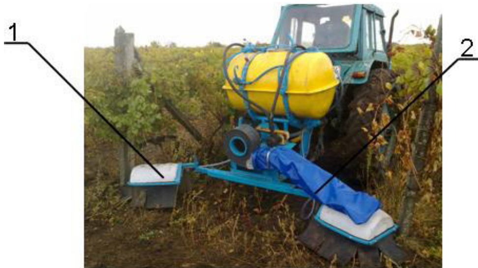
Рис.2. Лабораторно-полевая экспериментальная установка на-весного гербицидного опрыскивателя.
