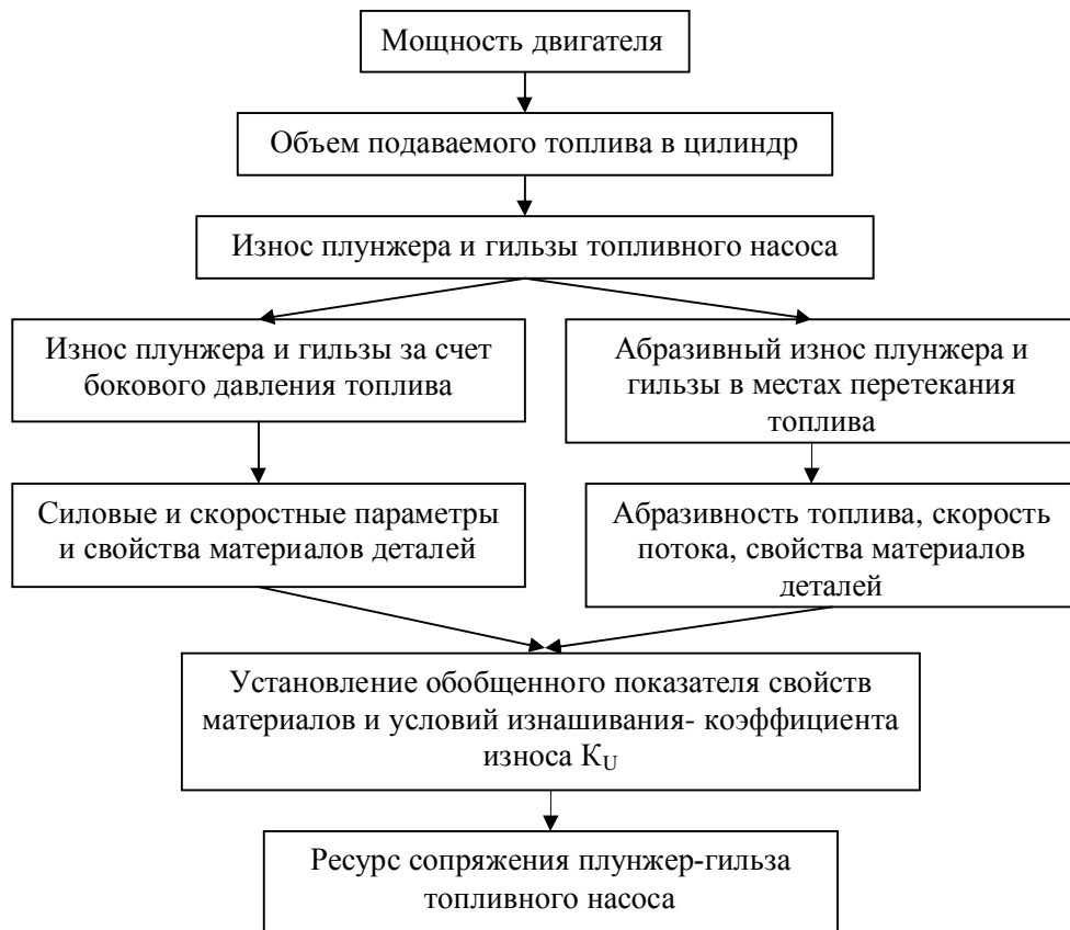
Рис. 1. Схема определения ресурса плунжерных пар топливного насоса.
