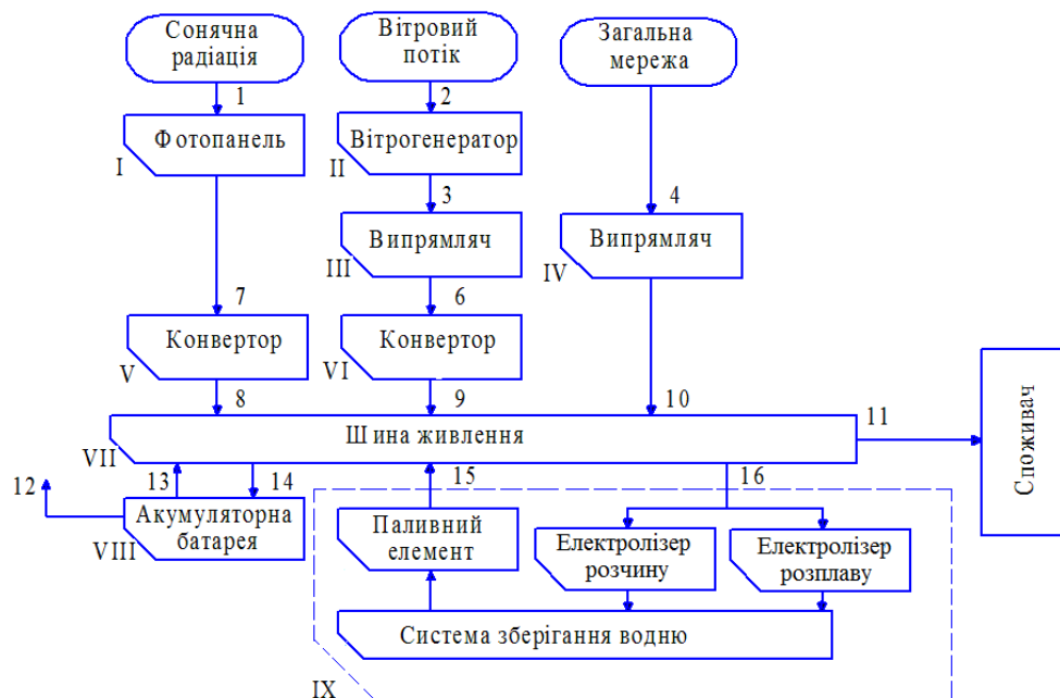
Рис. 1. Модель джерела живлення на основі паливних елементів.
