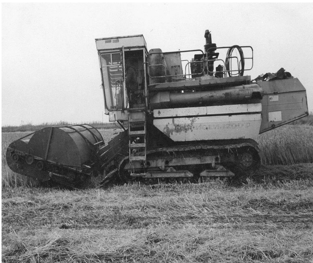
Рис. 1. Зернозбиральний комбайн обчисувального типу з різальним пристроєм.
