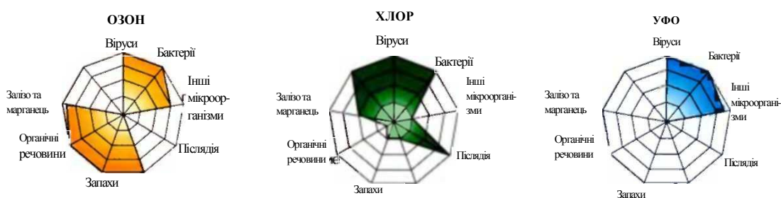
Рис. 3. Діаграми порівняння ефективності дії озону з хлоруванням та ультрафіолетовим опроміненням.
