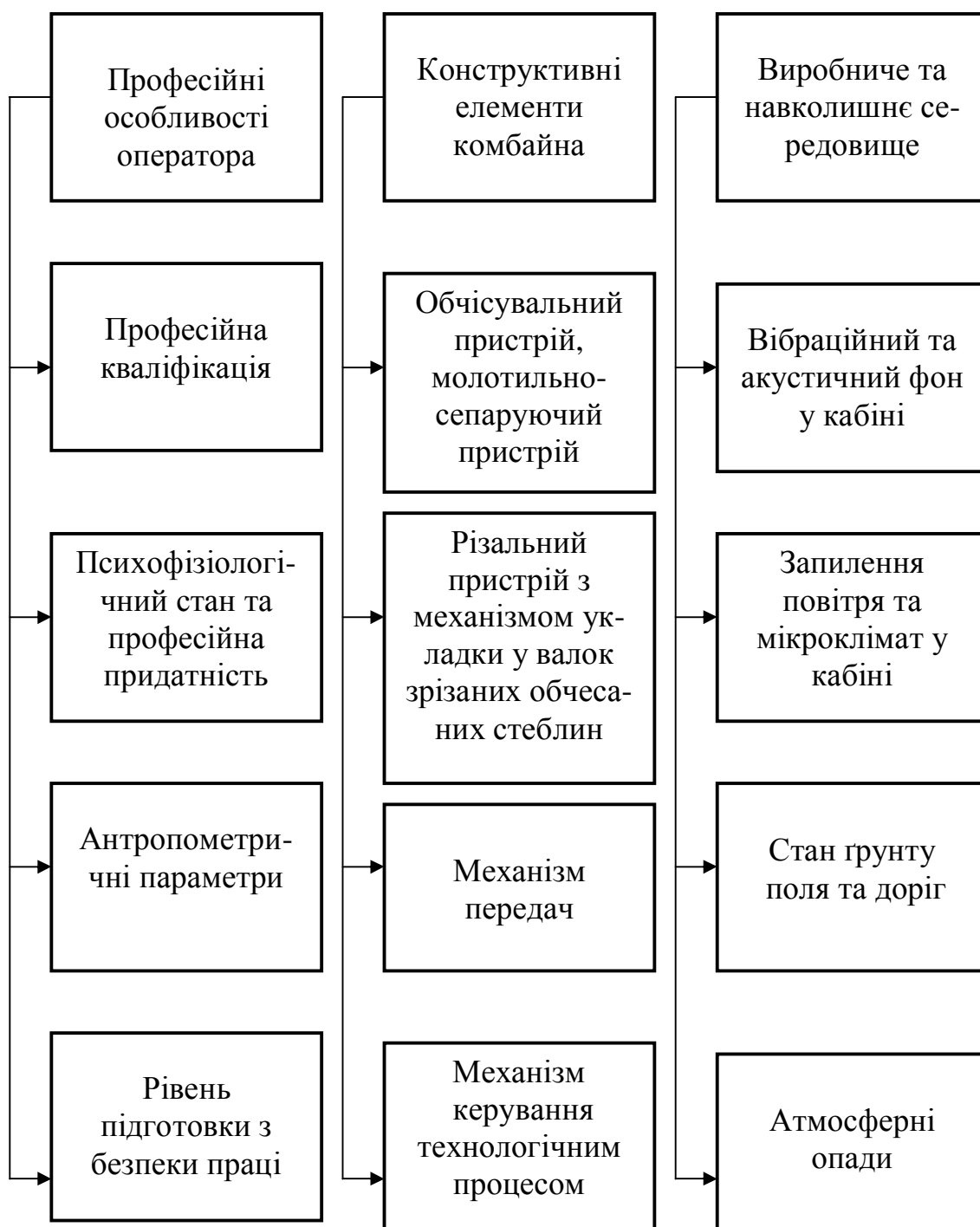
Рис. 3. Основні джерела та фактори небезпек в технологічній системі «оператор» - «комбайн обчисувального типу» - «середовище» (О-К-С).
