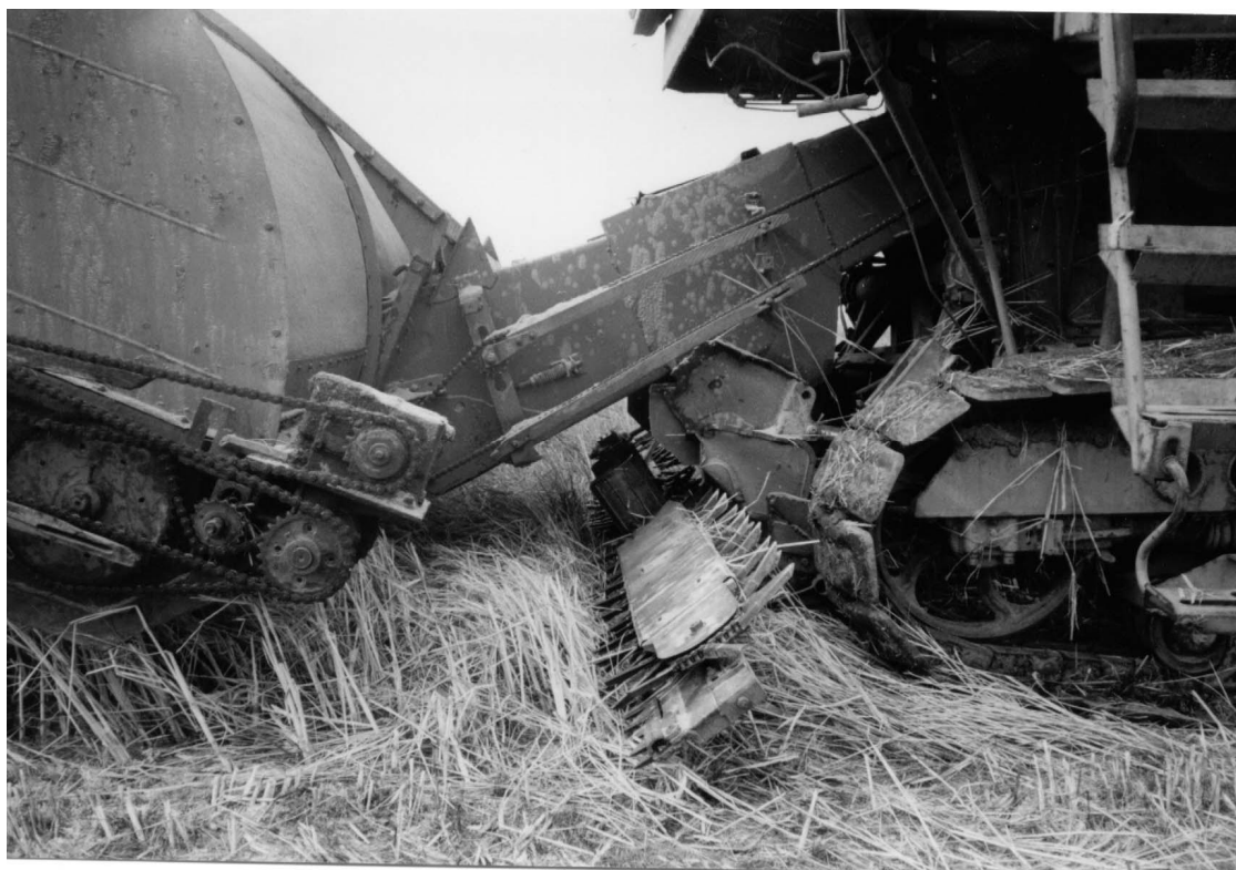
Рис. 2. Різальний пристрій сегментного типу с транспортуючим механізмом.
