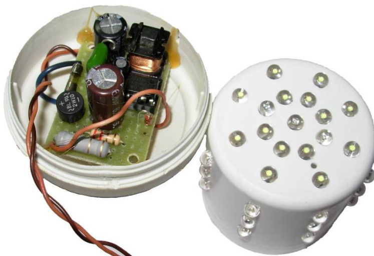
Рис. 3. Дослідний зразок світлодіодної лампи з світлодіодами розсіяного світла.
