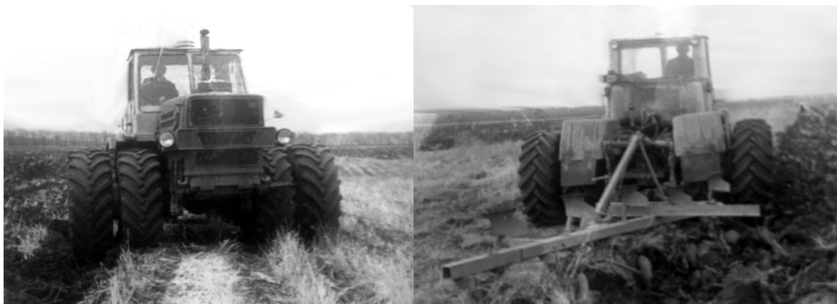
Рис.7. Трактор ХТЗ-150К-09 зі здвоєними шинами в агрегаті з плугом ПЛН-5-35: а – вид спереду; б – вид ззаду.
