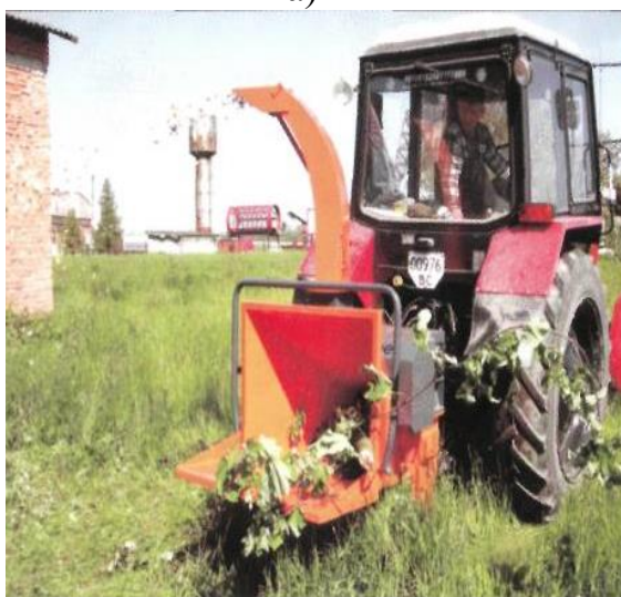
Рис. 1. Агрегати для подрібнення хмизу.
