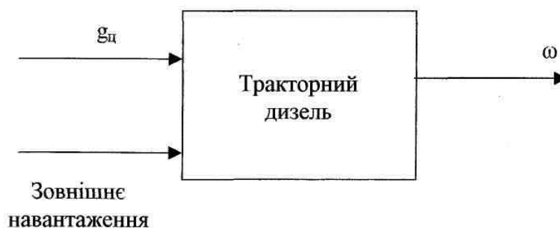
Рис. 1. Схема системи регулювання дизельного двигуна трактора.
