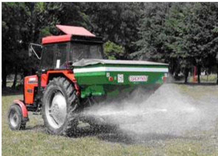
Рис. 9. Розкидач SIPMA N-049
