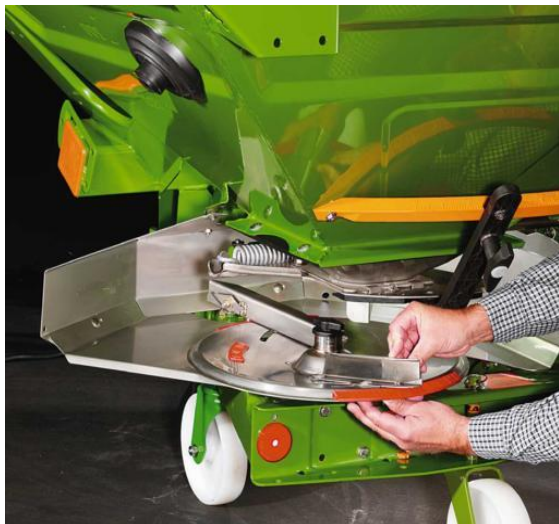
Рис. 16. Регулювання ширини розкидання мінеральних добрив на машині фірми Amazone.
