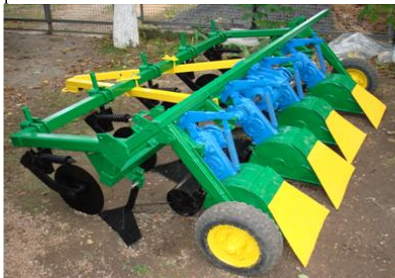
Рис. 4. Дослідний зразок подрібнювача рослинних залишків грубостеблових культур КФП – 2,8
