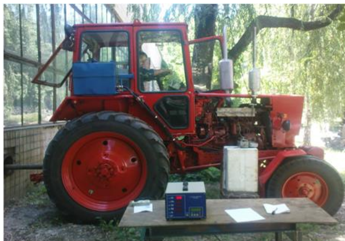
Рис. 4. Трактор ПМЗ-6АКЛ дообладнаний системою температурної підготовки дизельного біопалива
