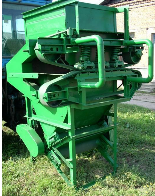
Рис.1. Селекційна молотарка льону-довгунця
