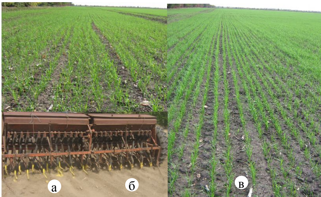
Мал. 4 - Порівняльні сходи озимої пшениці, посіяної: а – смуговими анкерними і б – дисково-анкерними сошниками; в – рядовими дисковими сошниками.
