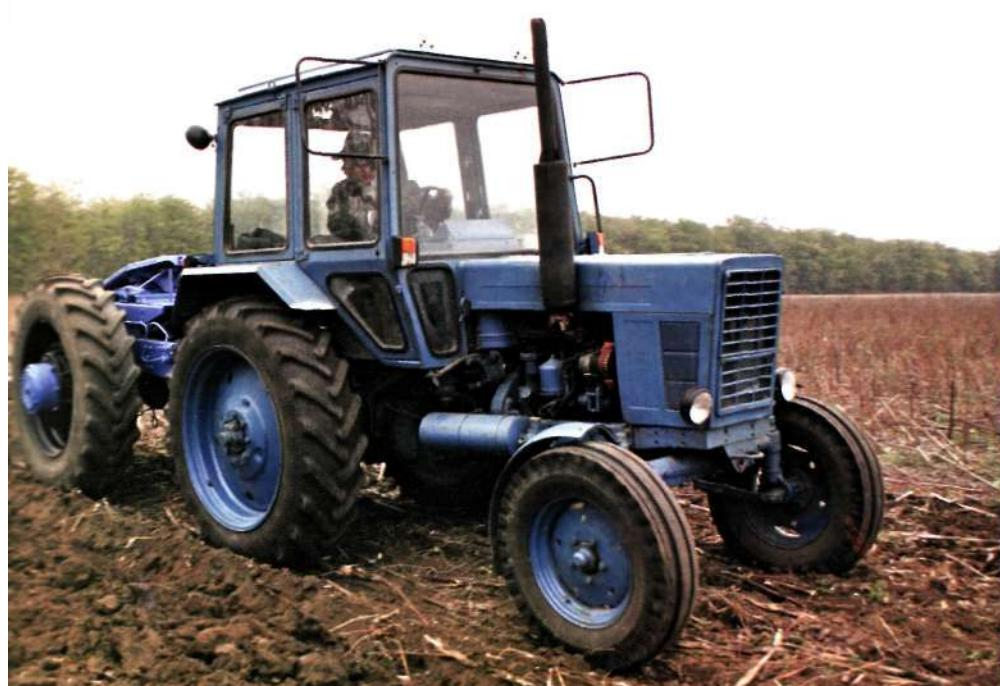
МЕЗ. Від'єднання технологічного модуля від енергетичного здійснювалось одним механізатором за 4–5 хвилин. За наявності немеханічного (електричного, гіdraulічного або іншого гнучкого) приводу коліс ТМ буде потрібно ще менше часу на його агрегатування з ЕМ.
