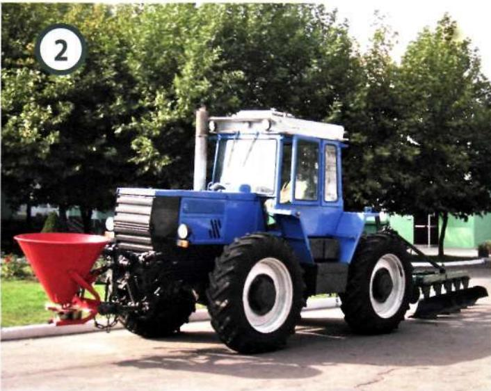
начіпляти валкову жниварку ЖВН-6Б, а на задній – начіпну борону типу БДН з шириною захвату 2,8–3,0 м. Розроблений та випробуваний нами агрегат за такою схемою за один прохід скошує посіви у валки і подрібнює ґрунт у міжвалковому ►
