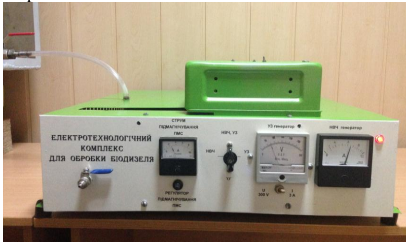
Рис. 1. Передня панель електротехнологічного комплексу для обробки сумішевого біопального
