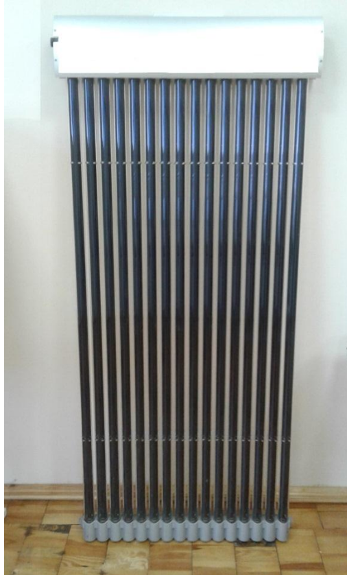
Рис. 5. Загальний вигляд батареї ФЕМ, що охолоджуються
