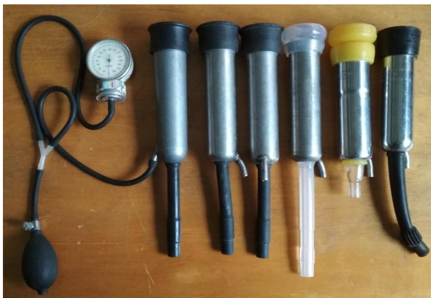
Рис. 1. Вигляд лабораторного пристрою та доїльних стаканів з циліндричною дійковою гумою різних виробників, для визначення надлишкового тиску при якому відбувається змикання гуми.
