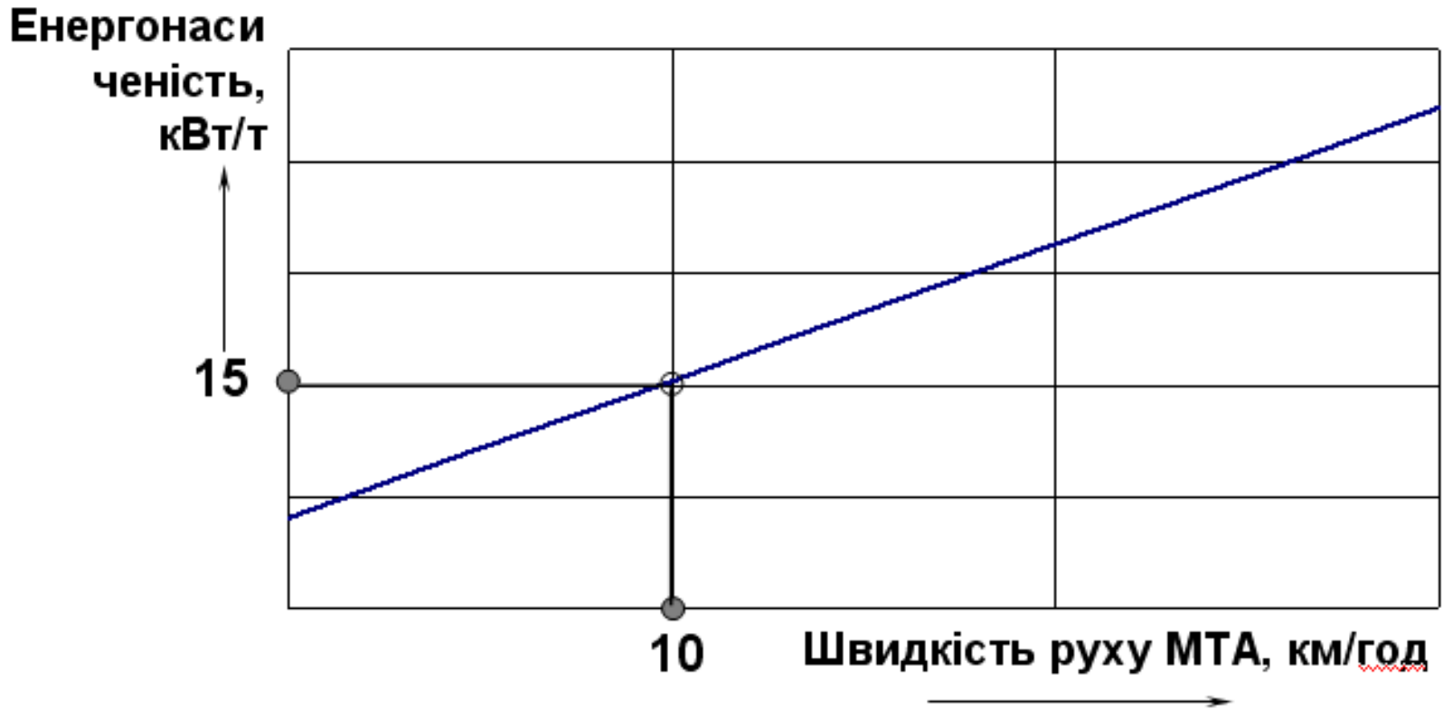
Рис. – Залежність енергонасиченості тракторів від швидкості руху МТА
