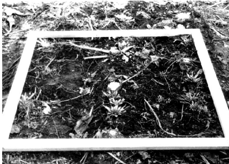
Рис. 5.5. Визначення якості видалення гички дослідною гичкозбиральною машиною
