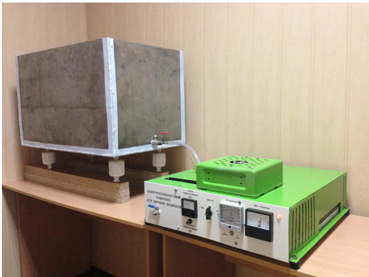
Рис. 5.1. Загальний вигляд електротехнологічного комплексу для обробки сумішевого біопального
