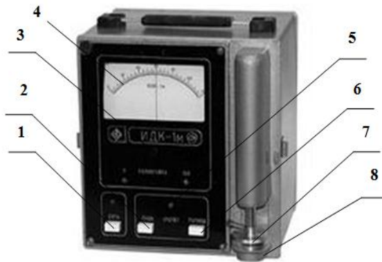
Рис. 1. Прилад ІДК-1: 1 – кнопка вмикання; 2 – кнопка «Пуск»; 3 – «калібрування» стрілки амперметра; 4 – шкала індикатора; 5 – лампочка «Відлік»; 6 – кнопка «Гальмо»; 7 – падаючий вантаж (пуансон); 8 – столик для кульки клейковини.
