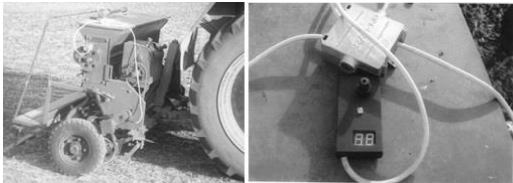
Рис. 3.12. Загальний вигляд сівалки СС-16, обладнаної САУВН з приводом через шестерні від крокового двигуна з МСБУ і МПУ
