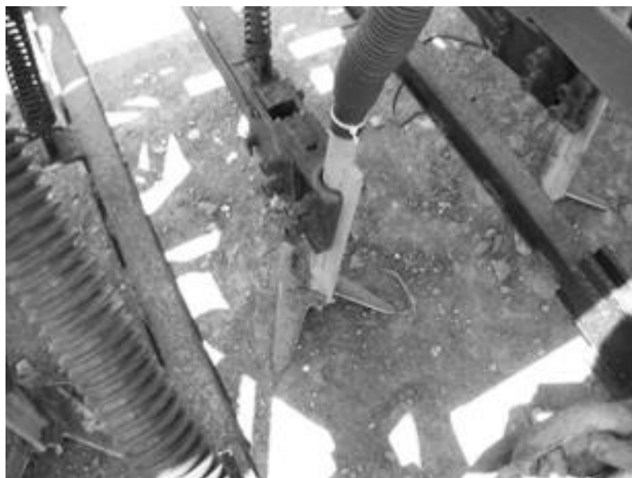
Рис. 3.22. Загальний вигляд фрагменту пристрою для кріплення сошників культиваторного типу до рядової зернової сівалки СЗ-3,6
