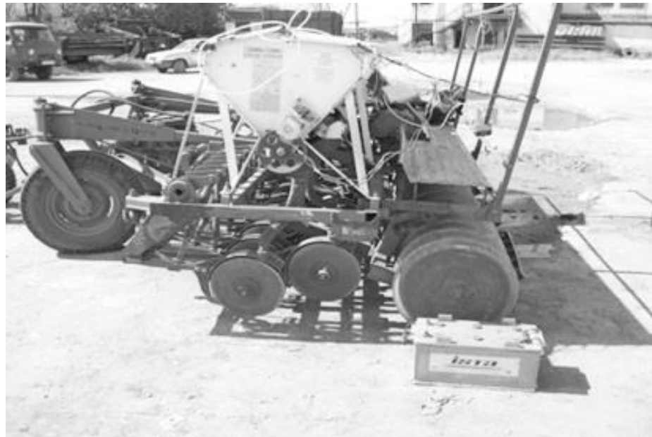
Рис. 3.13. Сівалка СЗП-3,6, обладнана САУВН з приводом через шестерні від крокового двигуна
