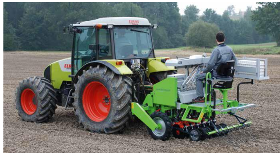
Рис. 1.9. Загальний вигляд касетної селекційної сівалки Rowseed-Wintersteiger в роботі
