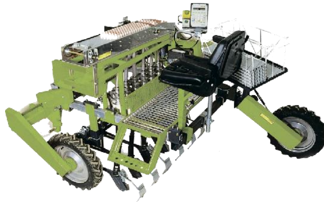
Рис. 1.13. Загальний вигляд касетної селекційної сівалки Rowseed-BIM Wintersteiger-BIM
