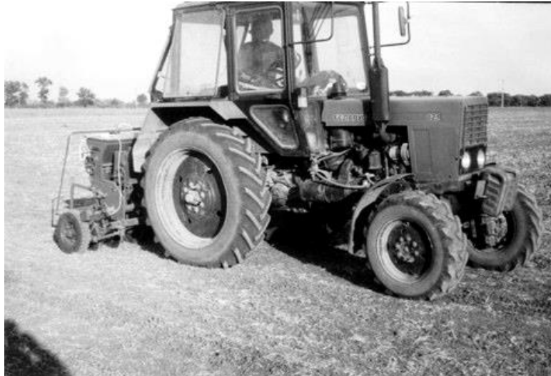
Рис. 3.34. Польові дослідження експериментального зразку системи автоматичного керування висівом насіння на сівалці СС-16
