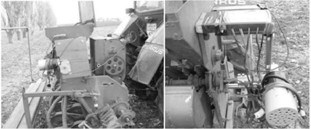
Рис. 3.14. Сівалка СС-16, обладнана САУВН з приводом від мотор-редуктора з колекторним електродвигуном
