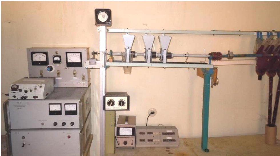
Рис. 5.7. Фрагмент станда для досліджень режимів роботи висівних апаратів
