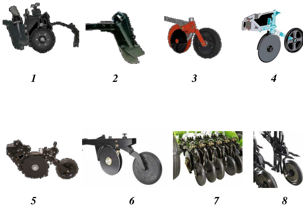
Рис. 1.27. Загальний вигляд і типи сошників, уніфікованих з сівалками Rowseed для підготовленого ґрунту:
