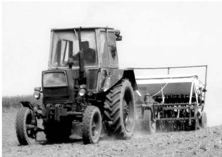
Рис. 3.35. Загальний вигляд експериментального агрегату СЗП-3,6 з електромеханічним приводом висівного апарату
