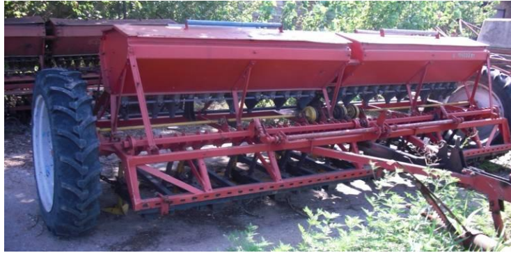
Рис. 5.13. Загальний вигляд модернізованої сівалки СЗ-3,6А для технології mini-till
