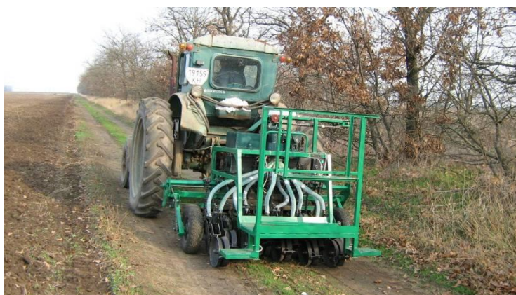
Рис. 5.12. Загальний вигляд сівалки селекційної СЦН-10 у транспортному положенні
