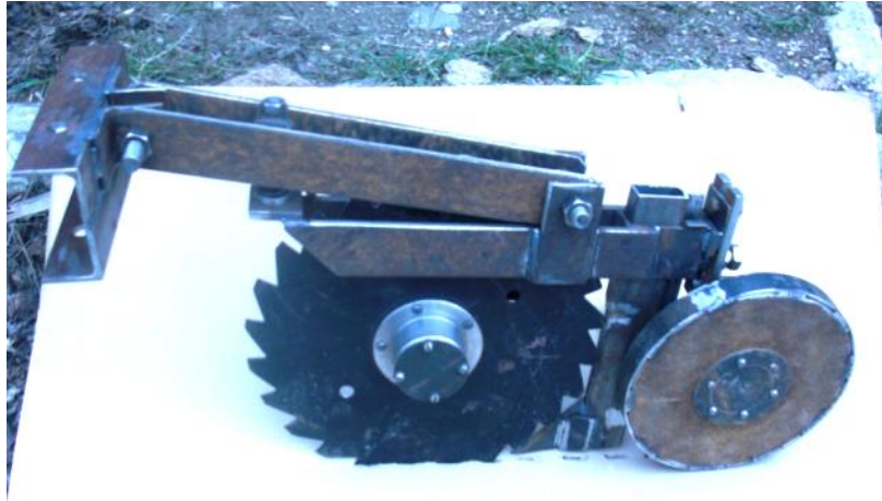
Рис. 3.26. Загальний вигляд універсального сошникового вузла з дисковим ножом, анкером-насіннепроводом і прикочувальним котком
