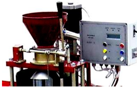
Рис. 1.49. Загальний вигляд системи автоматичного контролю висіву конусним апаратом сівалки Клен
