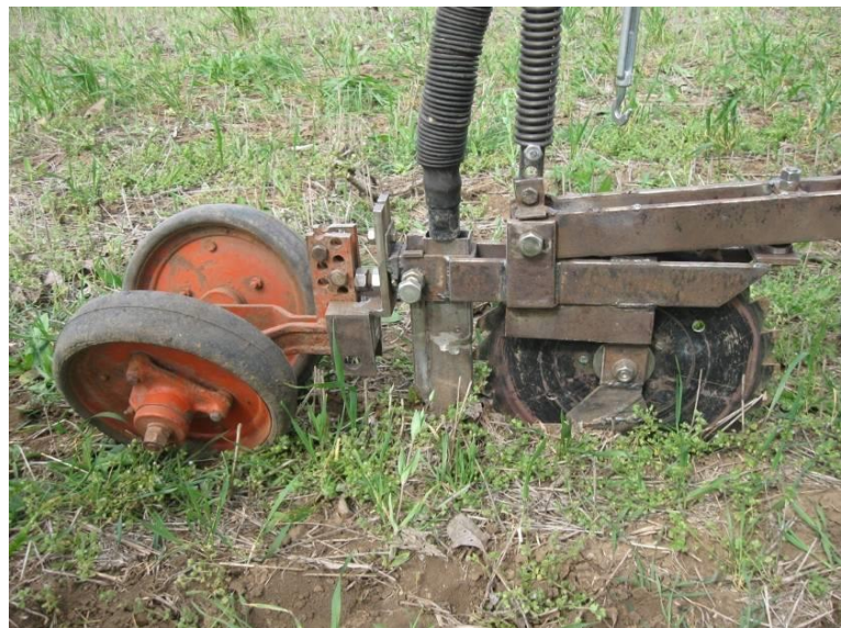
Рис. 5.4. Загальний вигляд сошникового вузла для селекційних сівалок при польовій апробації
