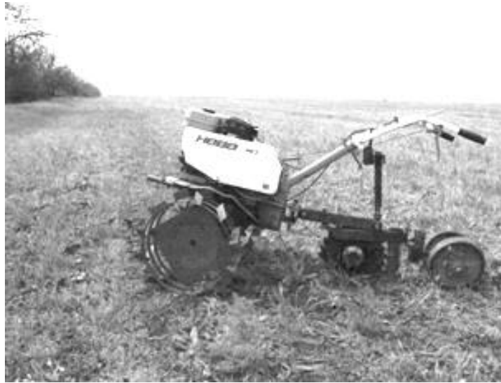
Рис. 3.37. Агрегат для дослідження на базі мотоблока «Нева»
