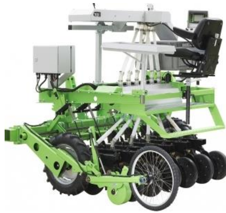
Рис. 1.11. Загальний вигляд сівалки навісної касетної селекційної Rowseed XL
