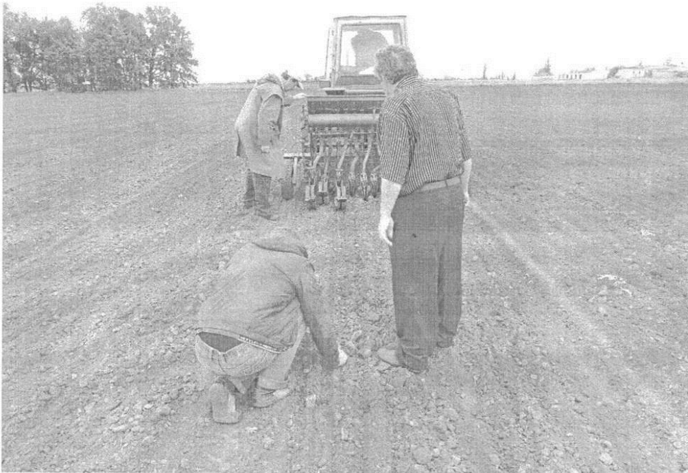
Рис.1. Загальний вигляд сівалки СН-16, обладнаної комбінованими дводисково-анкерними сошниками.
