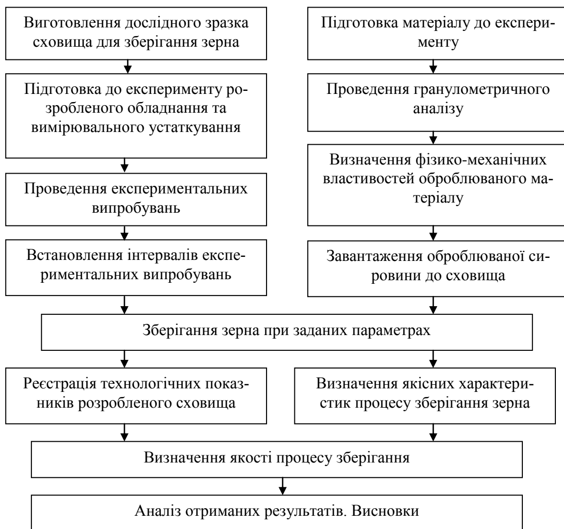
Рис. 2. Блок-схема підготовки та експериментальних досліджень процесу низькотемпературного зберігання зерна
