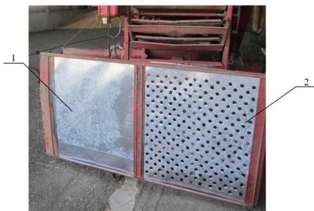
Рис. 4.6. Экспериментальный рабочий орган: 1 – сплошное решето (сегрегатор); 2 – решето с отверстием
