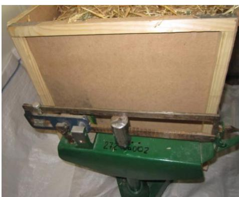
Рис. 2.14. Взвешивание отобранных проб очесанного вороха озимой пшеницы
