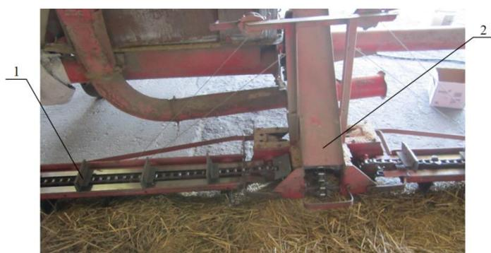
Рис. 4.7. Подача очесанного вороха в наклонный транспортер
