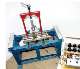
Рис. 5. Экспериментальная установка (нагрузочное приспособление)
