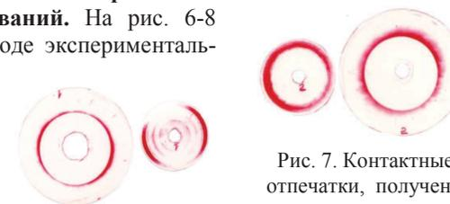
Рис. 6. Пробный оттиск в сопряжении матрица – заготовка – пуансон (нулевой зазор)
