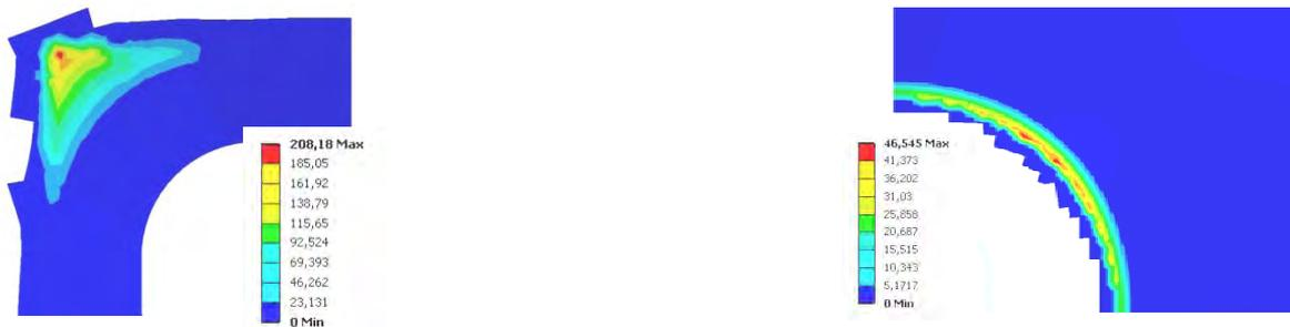
*Контактные давления в сопряжении пакет – нижняя базовая плита штампа*
