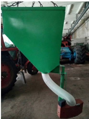
Рис. 9. Загальний вигляд дослідного зразка роздавача концкормів з індивідуальною дозованою видачею Fig. 9. Distribution of the feeder prototype with an individual dosage feed
