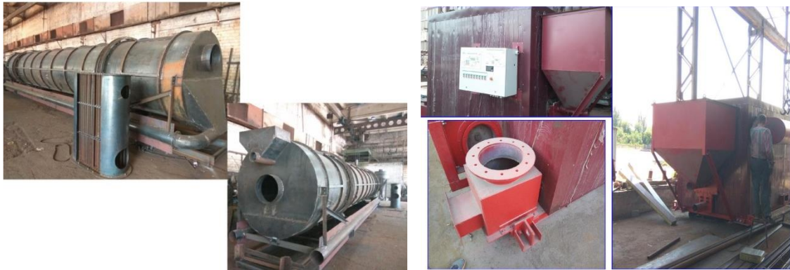
Рис. 6. Фотографии сушильного барабана и теплогенератора в процессе производства и монтажа.
