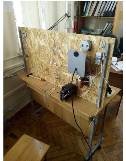
Рис. 3. Завершальний етап розробки стенду для виконання лабораторної роботи по дослідженню струмових реле РТ-40 та РТ-85 з дисципліни «Основи релейного захисту і автоматизація електроенергетичних систем» кафедра «Електроенергетики і автоматизації» ТДАТУ
