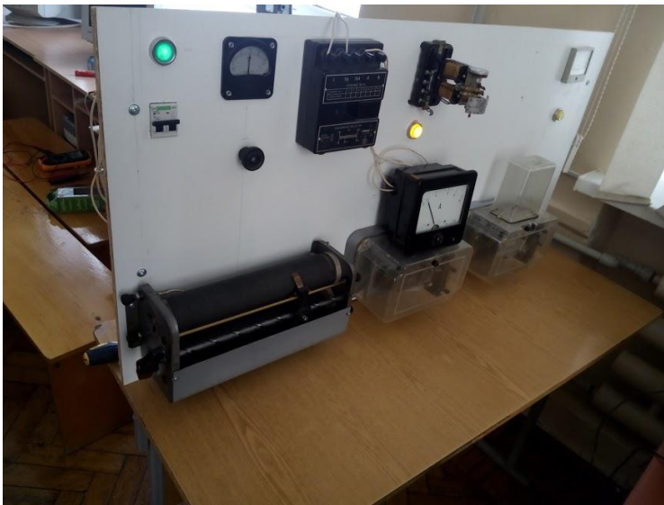
Рис. 3. Завершальний етап розробки стенду для виконання лабораторної роботи по дослідженню струмових реле РТ-40 та РТ-85 з дисципліни «Основи релейного захисту і автоматизація електроенергетичних систем» кафедра «Електроенергетики і автоматизації» ТДАТУ
