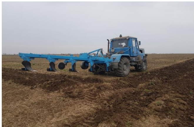
Рис. 2. Трактор ХТЗ170 з плугом, обладнаним текроновими полицями та польовими дошками
