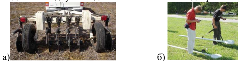
Рисунок 1- Контактний і безконтактний спосіб виміру електропровідності ґрунту
