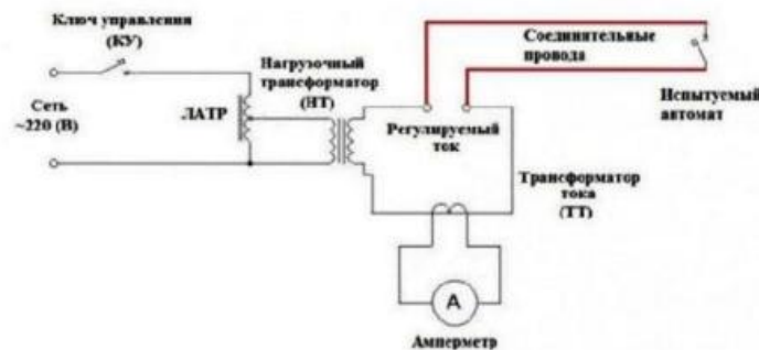
Рисунок 1 – Схема пристрою для перевірки параметрів автоматичного вимикача
