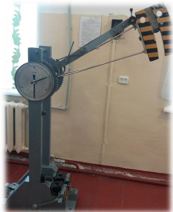
Рисунок 1.7 – Маятниковий копер МК-30: а) схема копра, б) зовнішній вигляд копра.
