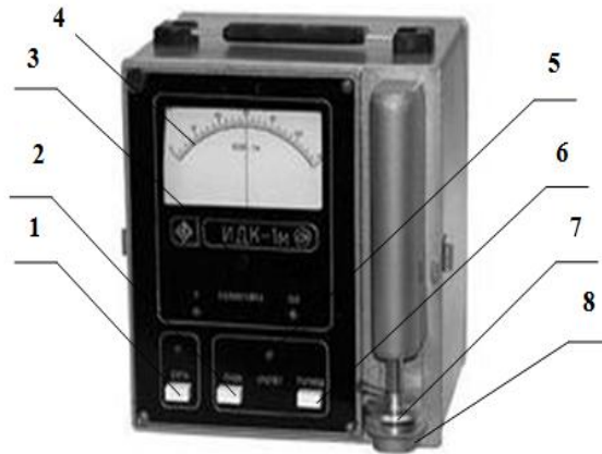
Рис. 2.15. Прилад ІДК-1: 1 – кнопка вмикання; 2 – кнопка «Пуск»; 3 – «калібрування» стрілки амперметра; 4 – шкала індикатора; 5 – лампочка «Відлік»; 6 – кнопка «Гальмо»; 7 – падаючий вантаж (пуансон); 8 – столик для кульки клейковини.
