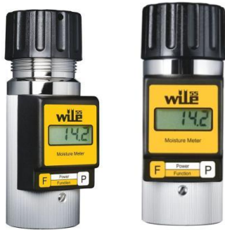
Рис. 2.12. Загальний вигляд вологоміра «Wile-55» для контролю вологості зерна.
