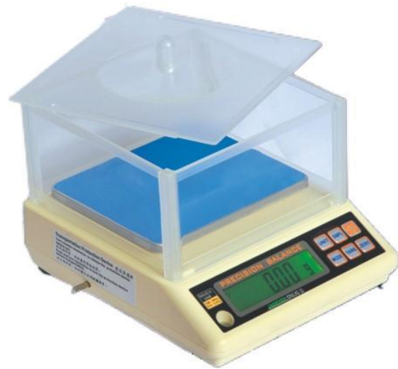
Рис. 2.10. Ваги лабораторні JADEVERSNUGII-150.
