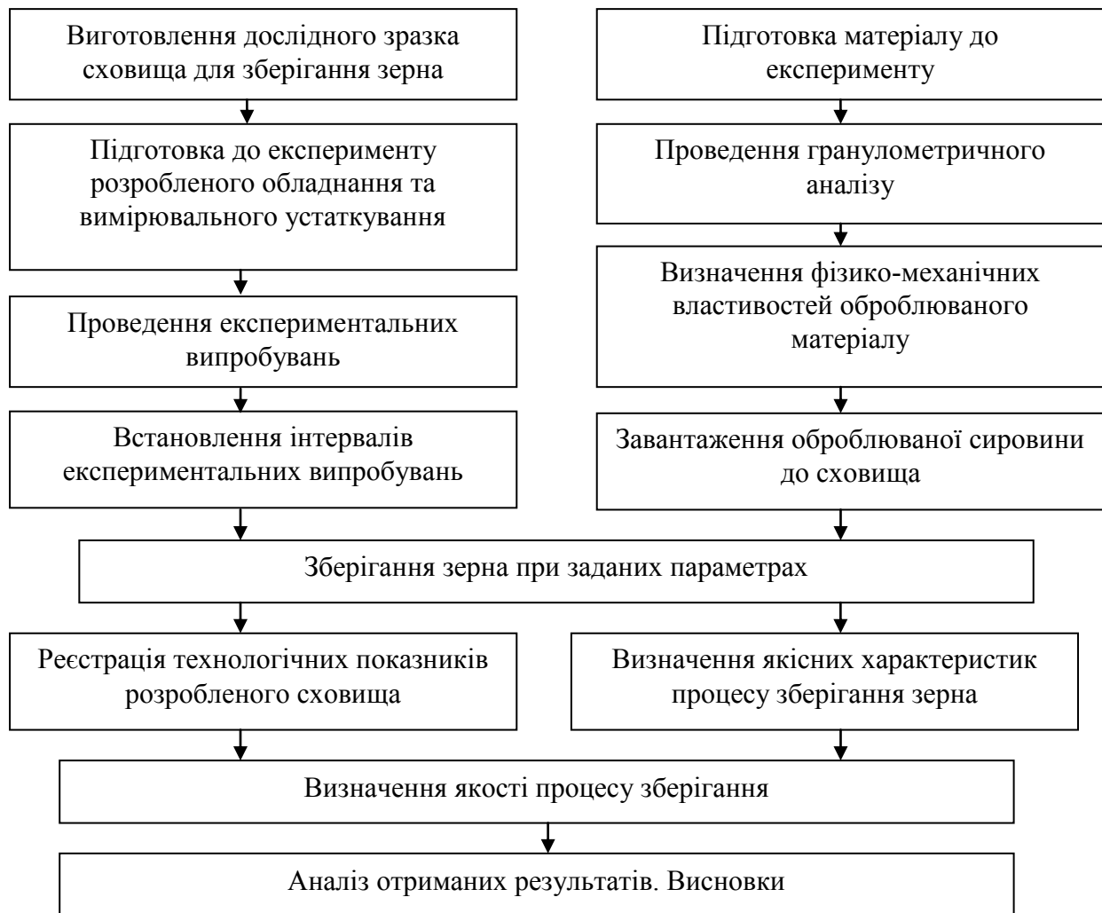
Рис. 2.1. Блок-схема підготовки та експериментальних досліджень процесу охолодження при зберіганні зерна.
