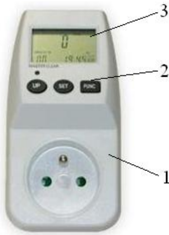
Рис. 2.9. Електронний ватметр EMF-1: 1 – корпус ватметра; 2 – панель керування; 3 – індикаторний дисплей.
