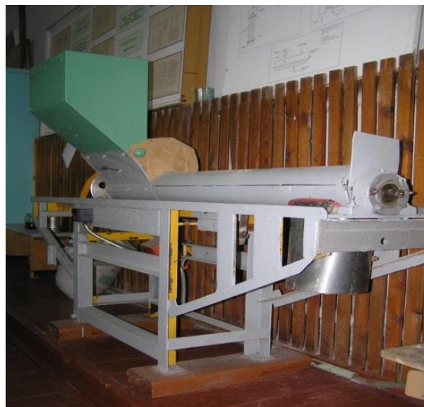
Рис. 2. Загальний вид гвинтового горизонтального змішувача сипучих компонентів
