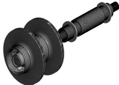
Рис. 14. SE модель ротору у зборі
