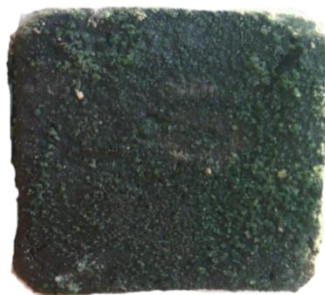
Рис. 1. Вогнетрив на основі неорганічного клею з відходів гальванічного виробництва та електрокорунду
