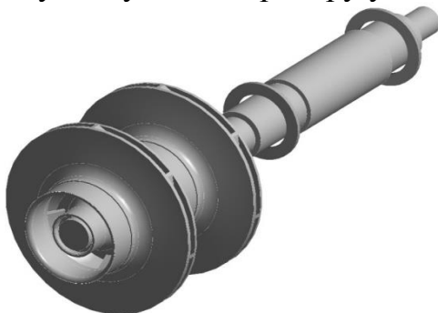
Рис. 13. Тривимірна розрахункова модель ротору у зборі
