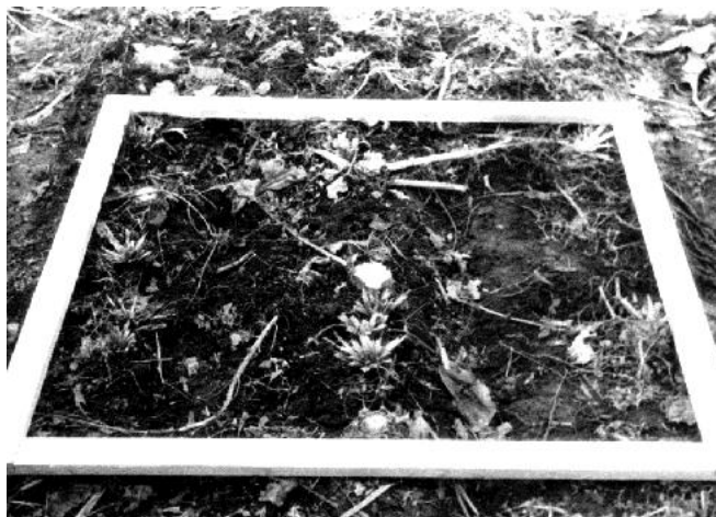
Рисунок 11 – Визначення якості видалення гички дослідною гичкозбиральною машиною
