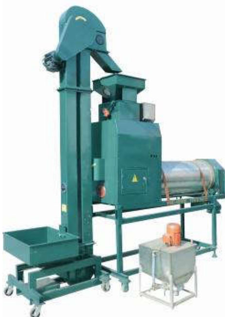
Рис. В.10. Зовнішній вигляд та технічна характеристика протруювача 5BYX
