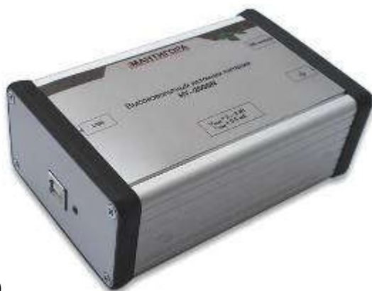
Рис. Д. 2. Високовольтні джерела живлення типу HV (а) та HT (б)
