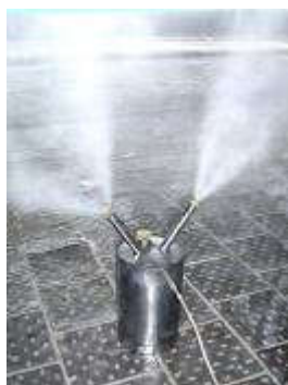
Рисунок Г.2. Струменевий аерозольний генератор САГ-5М: 1 – аерозоль; 2 – форсунки розпилення; 3 – заливна горловина; 4 – подача повітря; 5 – ручка
