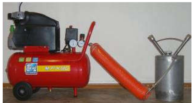
Рисунок Г.2. Струменевий аерозольний генератор САГ-5М: 1 – аерозоль; 2 – форсунки розпилення; 3 – заливна горловина; 4 – подача повітря; 5 – ручка
