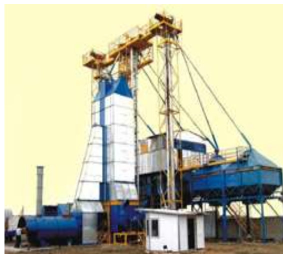
Рис. 1.13 – Зерноочистительно-сушильный комплекс ЗСК-30.
