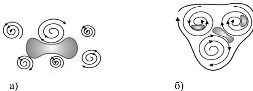
Рис. 1.7. Схематичне представлення механізмів турбулентного диспергування: а) ізотропний, б) в'язкісний.
