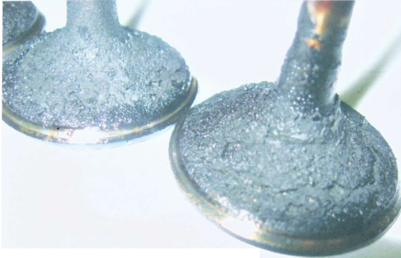
Рис.2. Нагар на випускному клапані.
