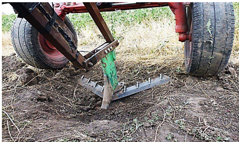
Рис. 3. Загальний вигляд експериментального робочого органу з активаторами розпушування: 1 – плоскоріз КПГ – 2-150; 2 – експериментальний робочий орган; 3 – активатори розпушування; 4 – паралелограмний механізм; 5 – тензоланка
