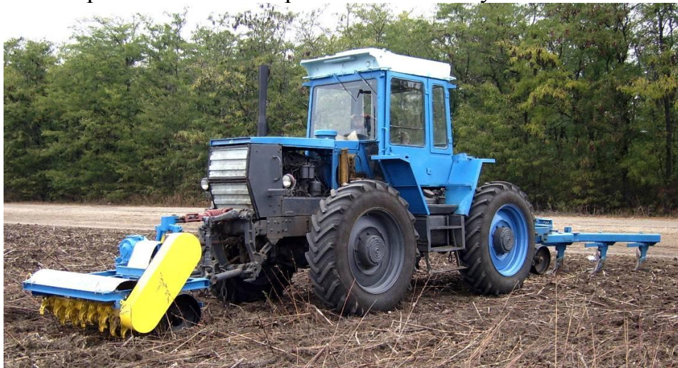
Рис. 1. Агрегат за схемою «push-pull» на основі орно-просапного трактора серії ХТЗ-160.
