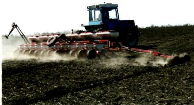
Рис. 3. Посівний агрегат у складі трактора ХТЗ-16131 та 12-рядної просапної сівалки «Optima»
