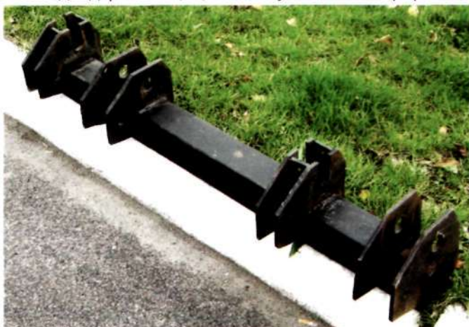
Рис. 1. Пристрій для асиметричного навішування просапної сівалки на трактор
