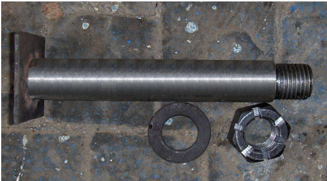
Рис. 8. Відновлений палець із конструктивними змінами.
