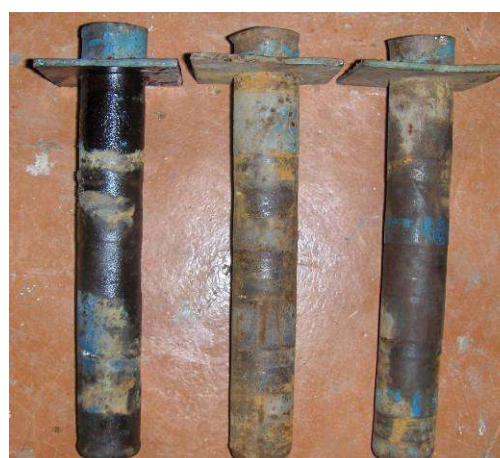
Рис. 5. Зноси деталей ходової частини культиватора КПС-4.
