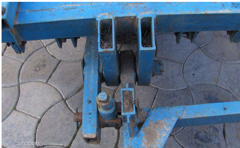
Рис. 10. Стан ходової частини культиваторів КПС-4 після року експлуатації.
