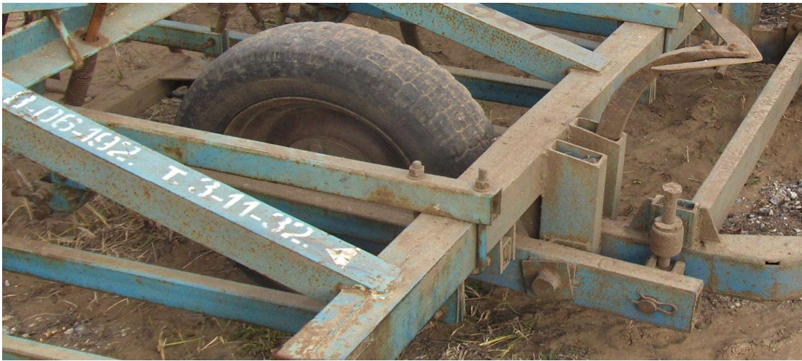
Рис. 3. Загальний вид ходової частини культиватора КПС-4.
