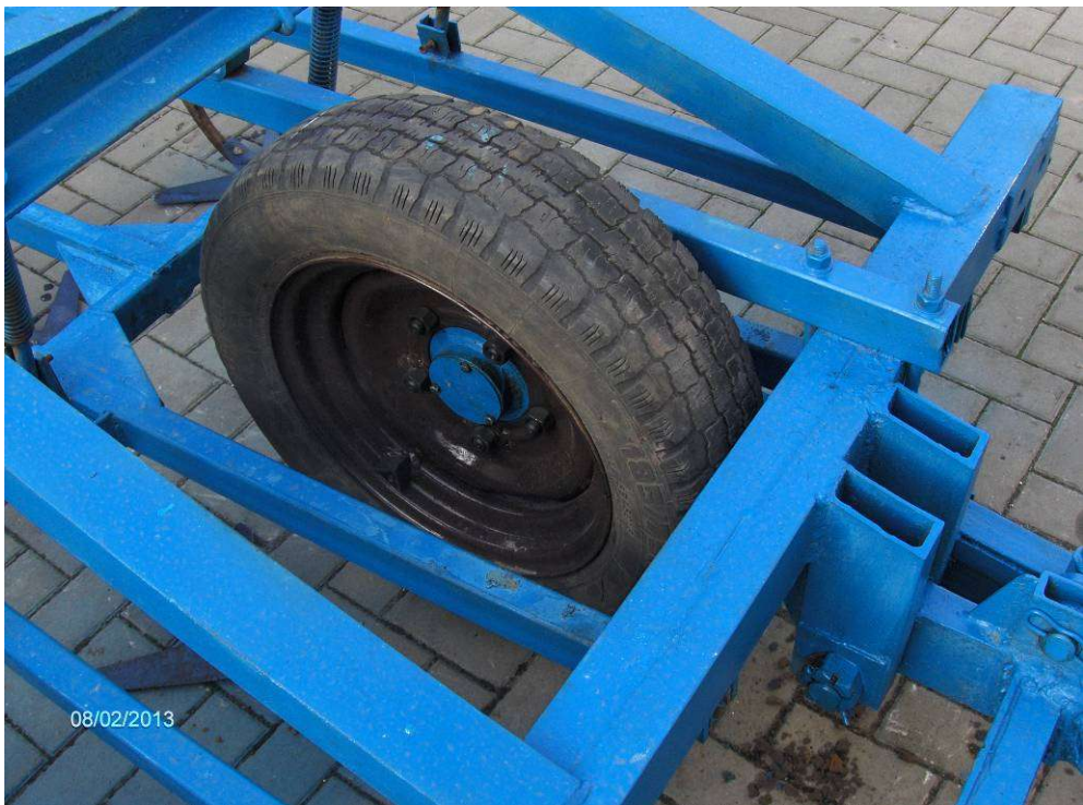
Рис. 9. Відновлена та удосконалена ходова частина культиватора КПС-4.
