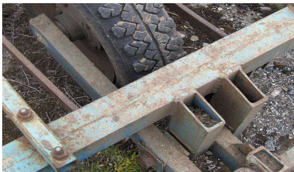
Рис. 4. Зазор між кронштейном та стійкою рами.
