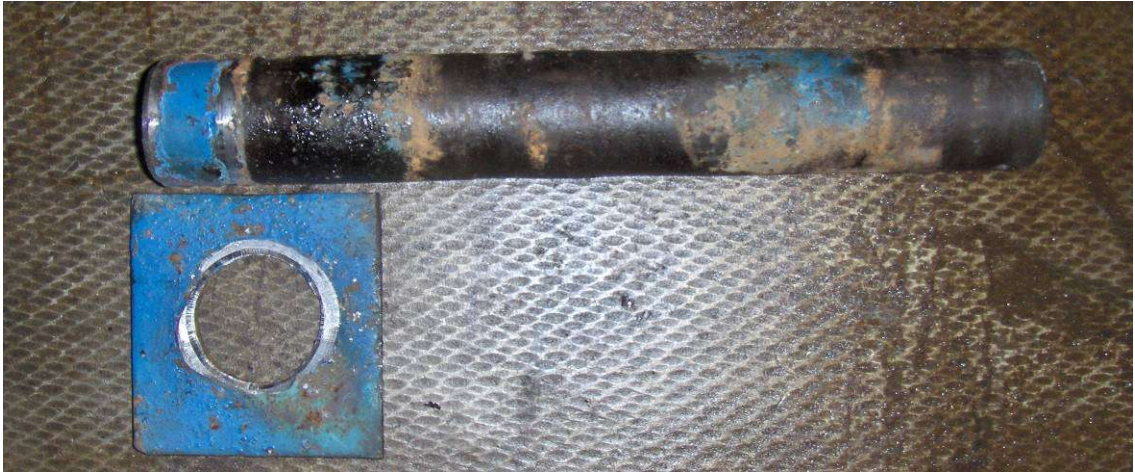
Рис. 7. Підготовка пальця для відновлення.
