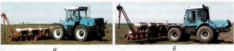
Рис. 1 – Дванадцятьирядні просапні МТА на основі тракторів серії ХТЗ-160 (а) і ХТЗ-170 (б)
