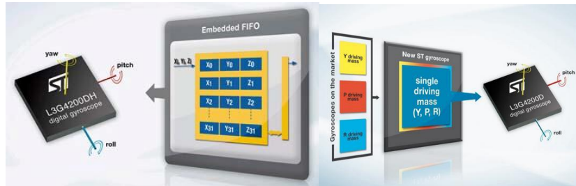
Рис. 5. Трьохосьовий гіроскоп L3G4200D/DH з цифровим виходом
