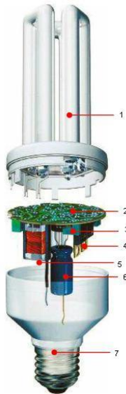
Рисунок В15 – Загальна будова компактної люмінесцентної лампи: 1 – скляна трубка із шаром люмінофору; 2 – терморезистор з позитивним температурним коефіцієнтом для миттєвого запуску без мерехтіння; 3 – пристрій подавлення радіоперешкод; 4 – перемикаючі транзистори; 5 – стабілізатор струму лампи; 6 – конденсатор, який забезпечує роботу лампи без мерехтіння; 7 - цоколь
