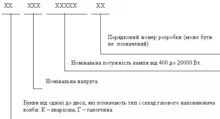
Рисунок 1.33 – Позначення галогенних лампи загального освітлення
